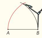
Usando la misma abertura del paso anterior, dibujó un arco centrándolo en B.
