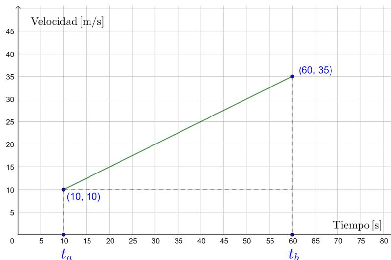
La distancia recorrida se obtiene sumando las áreas del triángulo de base  $(60 - 10)$  y altura  $(35 - 10)$  con el área del rectángulo de ancho  $(60 - 10)$  y altura  $(10 - 0)$ . De este modo:
