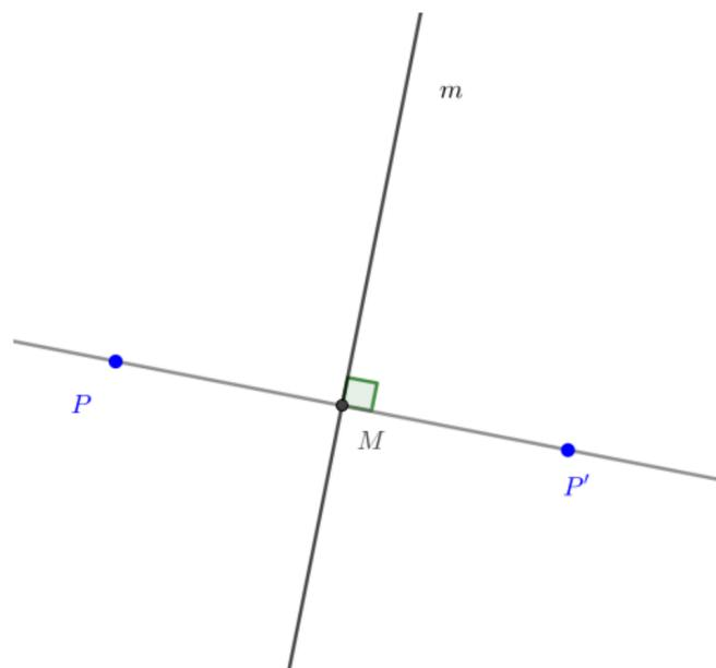
Este procedimiento permite obtener un **único** punto  $P'$ , correspondiente a la reflexión de un punto  $P$  con respecto a una recta  $m$ .
