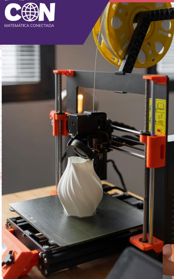
Las **impresoras 3D** utilizan un proceso conocido como fabricación aditiva, que implica agregar material capa por capa para construir el objeto deseado.
